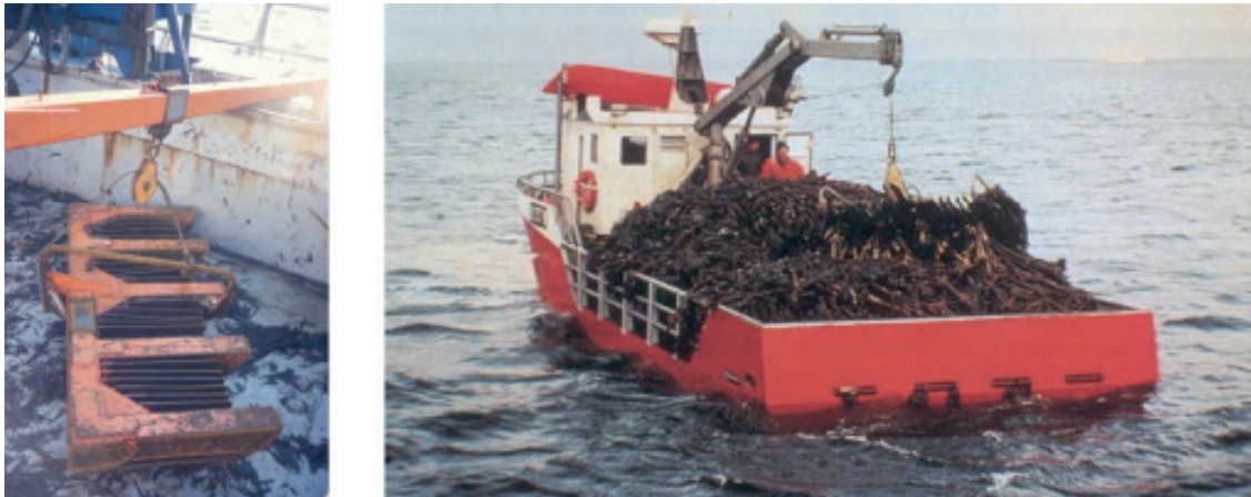
FIGUUR IX.2 LINKS: EEN SLEEPMAAIER. RECHTS: EEN VAARTUIG VOOR HET OOGSTEN VAN ZEEWIER (ZEEWIER DREDGER), ZOALS GEBRUIKT IN NOORWEGEN
