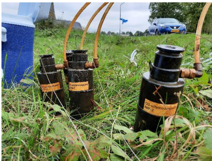
Figuur B7.2 Reservoirs waarin de SorbiCells bevestigd worden.
