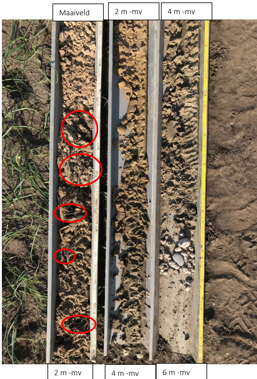
Figuur B8-3 Boorprofiel onder het cichoreiperceel tussen 1,1 en 2,2 m -mv grove houtresten, aangegeven met de rode cirkels.
