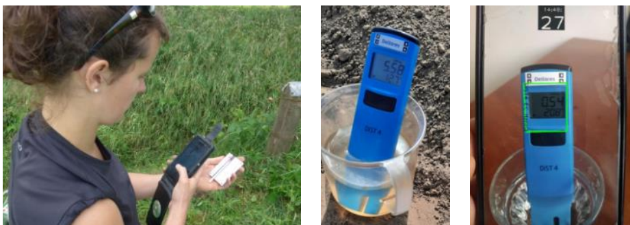
Figuur B1.2 Gebruik van de Nitraat App voor metingen van nitraatconcentraties (links) en EC (middel en rechts)
