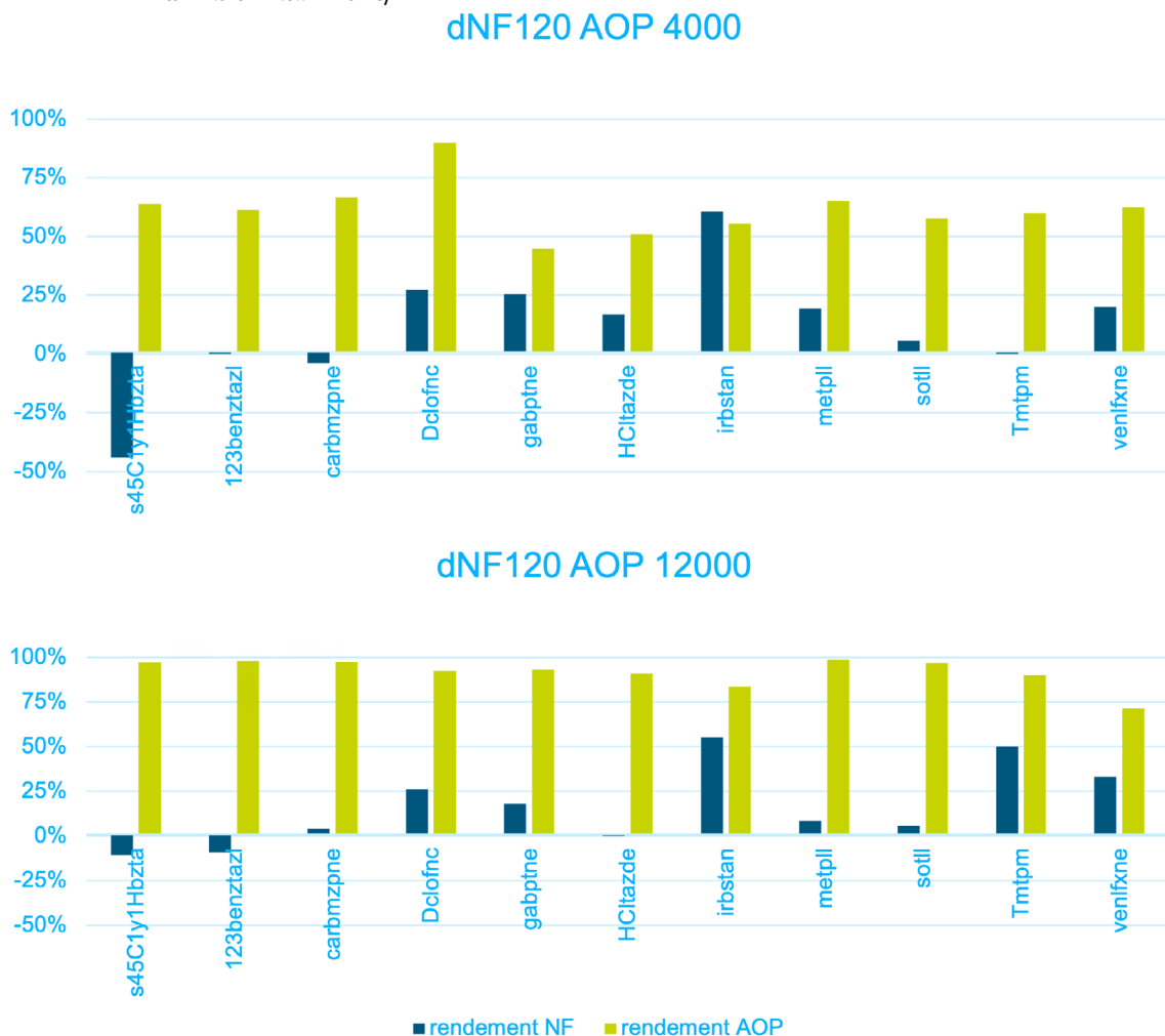
FIGUUR 7 VERWIJDERINGSRENDEMENTEN VOOR DE GIDSSTOFFEN BIJ DNF120, EN TWEE INSTELLINGEN VOOR AOP; DOSERING VAN WATERSTOFPEROXIDE 20 MG/L
