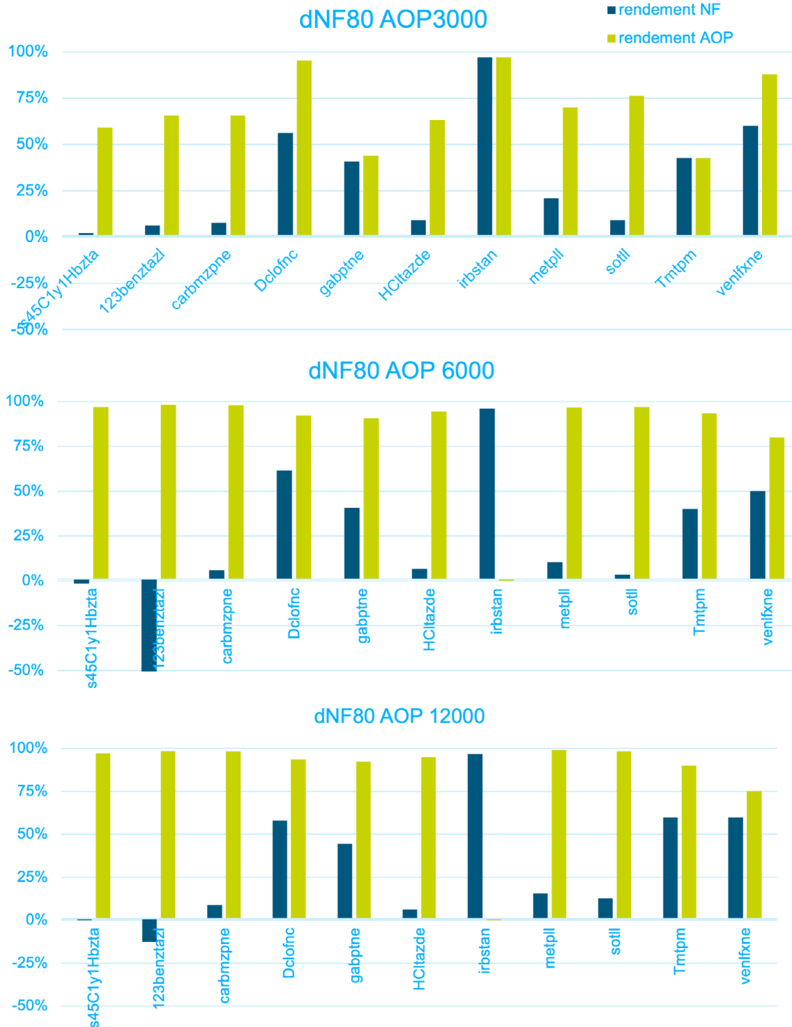
FIGUUR 6 VERWIJDERINGSRENDEMENTEN VOOR DE GIDSSTOFFEN BIJ DNF80, EN DRIE INSTELLINGEN VOOR AOP; DOSERING VAN WATERSTOFPEROXIDE 10 MG/L
